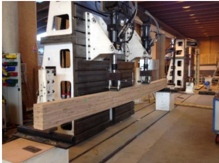
Illustration 5 : test de résistance mécanique sur une poutre BLC de chêne
