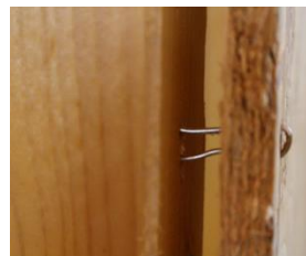
Illustration 5 : Mode d'endommagement du mur après répliques du séisme à 1g.
