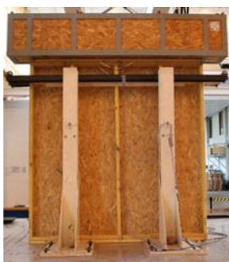
Illustration 1 : Dispositif pour les essais sur table vibrante et détails des murs
