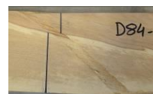
Illustration 2 : Mesure du module en vibratoire, test de flexion en continu, rupture au nœud et pente de fil
