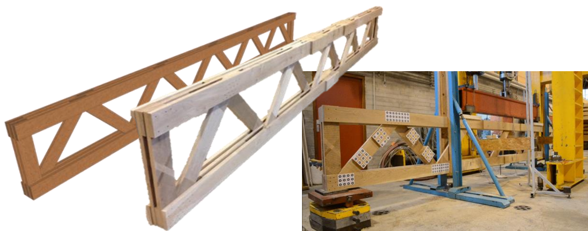
Illustration 4 : Dessin, réalisation et test de poutres en lames de chêne issues de grumes classe C et D [16].
