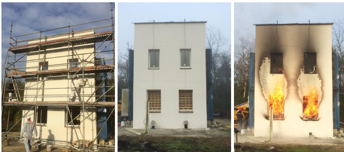
Illustration 2 : Différentes phases de préparation de la maquette d'essai (en cours d'enduisage ; juste avant la mise à feu ; hauteur de flammes à la fin de l'essai)
