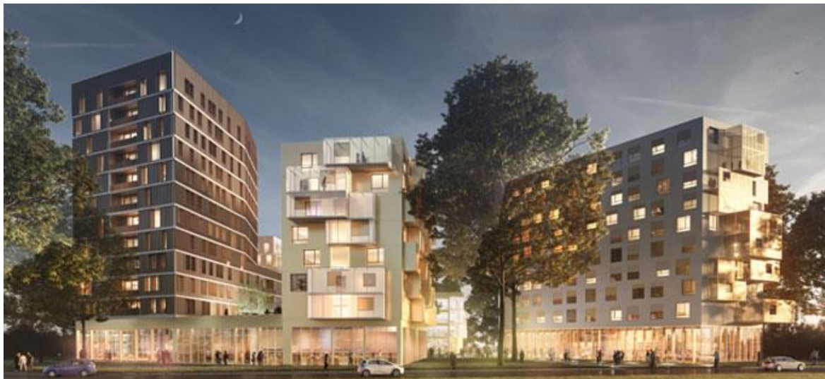
Treet It, futur immeuble R+11 à la Cité Descartes (plus haute construction bois de France), à Champs-sur-Marne comprenant des bureaux, une résidence étudiante, des commerces et des services. © ADIM-Vinci Construction
