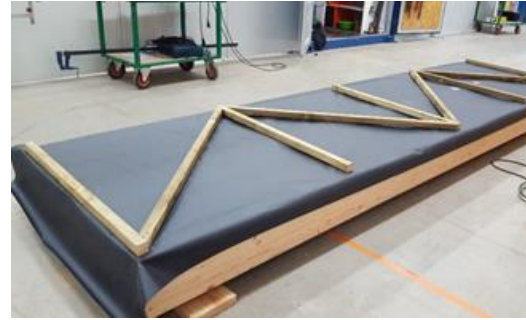
Figure 5 : Sous-face d'un module de toiture (©ESB)
