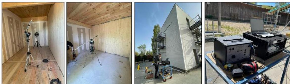
Ces essais ont permis de réaliser de nombreuses analyses en particulier sur le recalage des calculs prédictifs réalisés selon la norme ISO 12354-1 parue en 2017 incluant les indices d'affaiblissement vibratoire Kij évalués sur la maquette. Le format du FBC ne permet pas de présenter l'ensemble des résultats qui sont néanmoins disponibles sur le site extranet d'ADIVBois. La présentation sera donc centrée sur la présentation de deux exemples de solution avec bois apparent.
