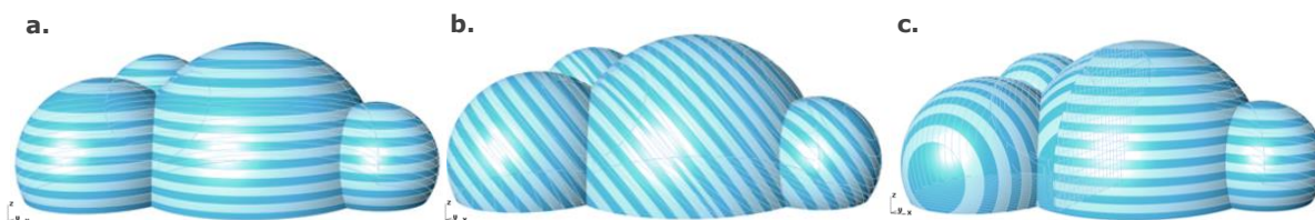
Illustration 7 : Différents exemples de directions de tranchage : a. par plan horizontal (selon l'axe vertical \vec{z} ) ; b. par plan incliné (selon un axe incliné) ; c. par plans de tranchage multiples (un premier niveau de tranchage selon l'axe \vec{x} puis un second niveau selon l'axe \vec{y} d'une part et l'axe \vec{z} d'autre part).
