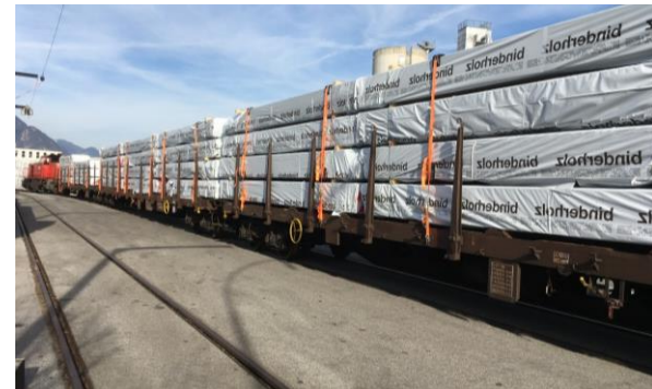
Images 6 et 7 : chargement de poutres lamellé-collé et convoi mixte de CLT BBS et lamellé-collé
