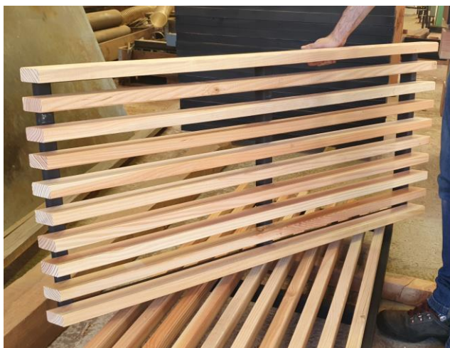
Fixation des tasseaux de finition des Sylvacoustik
