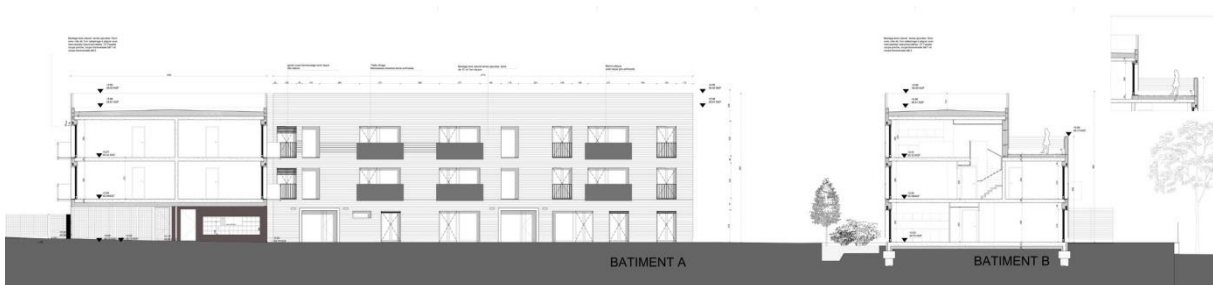
Coupe longitudinale bâtiment A et B
