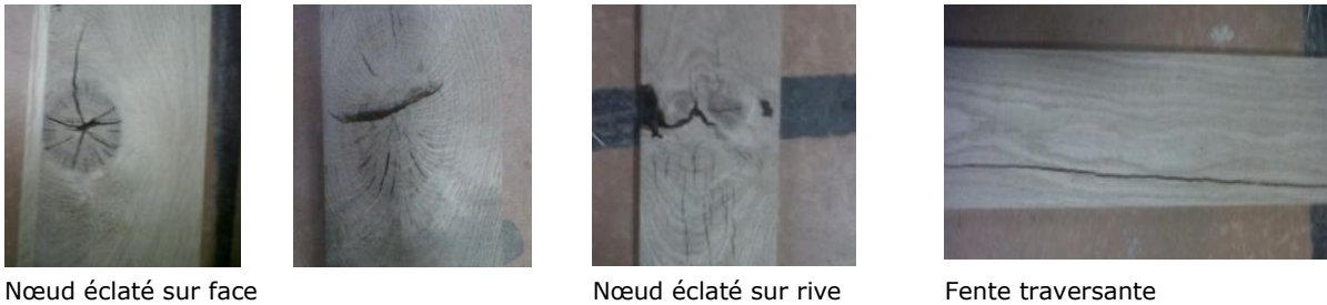
Figure 4: Exemples de défauts rédhibitoires en classement visuel pour un emploi des bois en structures
